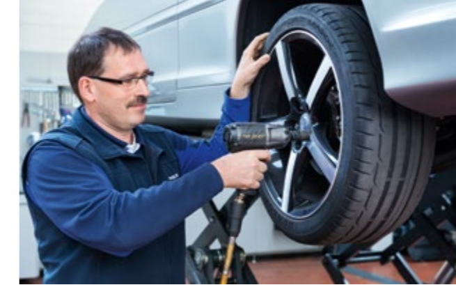
Christoph Reintges legt an der Volvo-Bühne selbst Hand an. Der Rodcraft-Schrauber RC2277, auch „das Beast“ genannt, ist zu Radwechsel-Zeiten dauerhaft im Einsatz und muss auch mit rauem Umgang zurechtkommen.
